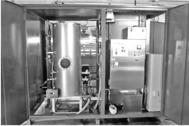
MBO促進酸化処理工法の装置
